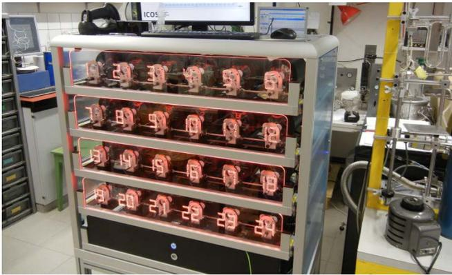
Figure 4. Autosampler for the ICOS-Station Jungfrauoch.
